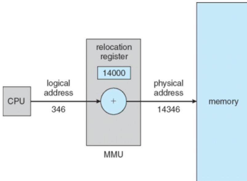
Por ejemplo, si la base se encuentra en la dirección 14000, cualquier intento del usuario de direccionar la posición de memoria cero se reubicará dinámicamente en la dirección 14000; un
