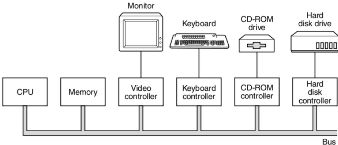
Tener en cuenta que el diagrama esta simplificado ya que el bus esta compuesto por el bus de datos, de direcciones y de control
