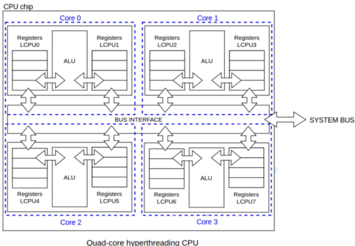
Al contrario que en el caso de la tecnología HyperThreading, en este caso sí tendríamos a todos los efectos varias cpus completamente independientes, una por cada core o núcleo. De hecho de cara al rendimiento es mejor tener un único procesador multicore que el número equivalente de CPU's de un solo core en una misma placa. Por supuesto seguiría siendo mejor tener 2 procesadores dual-core que uno solo, pero aún mejor sería tener un único quad-core.
