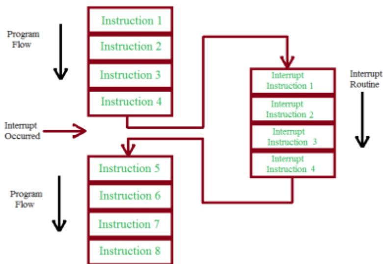
Existen dos tipos de interrupciones: hardware y software. Las interrupciones hardware son aquellas en las que su activación está condicionada por el hardware del sistema, ya sea por:
